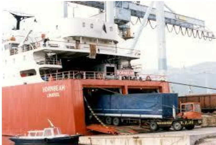
Slika 10: Ukrcaj cestovnih vozila pomoću posebno građenih Ro-Ro brodova
