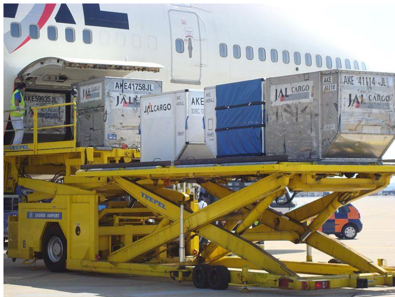
Slika 13: Istovar LD3 kontejnera iz Boeinga 747
