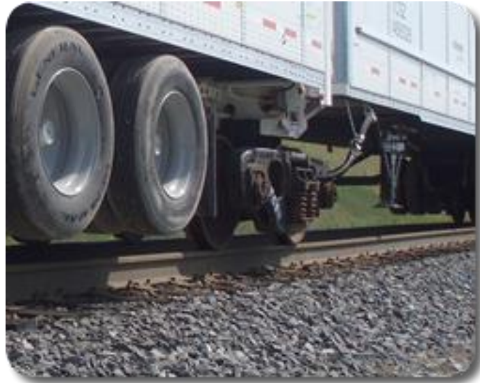
Slika 8: Bimodalni sustav transporta
