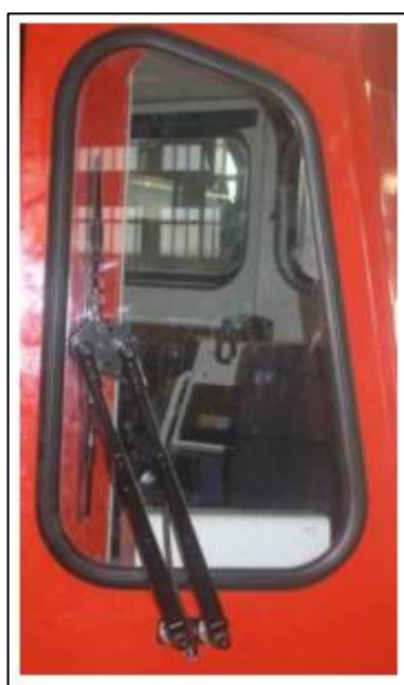
Slika 11. Električni brisači stakla na vratima
