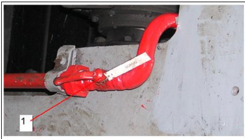
Slika 29. Slavina za zatvaranje napajanja goriva dizel motora (1)
