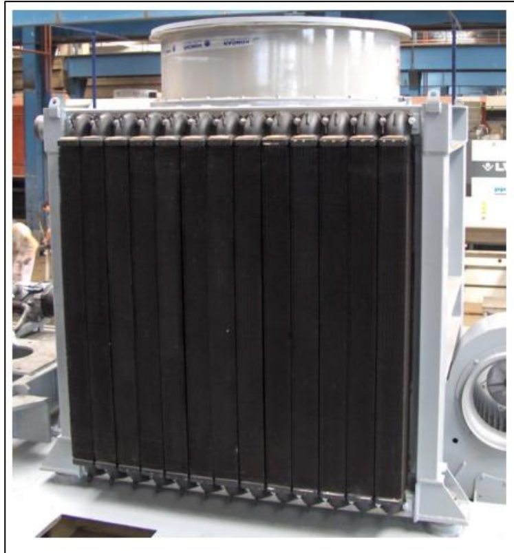
Slika 21. Sklop novog hladnjaka
