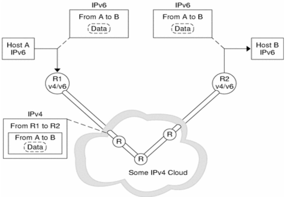
Slika 22. Mehanizam tuneliranja [33]
