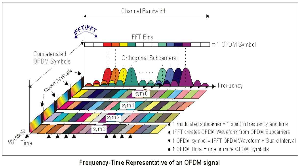
Slika 14. Frekvencijsko-vremenski odnos OFDM signala [21]
