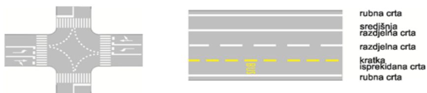
Slika 18. Kratka isprekidana crta
