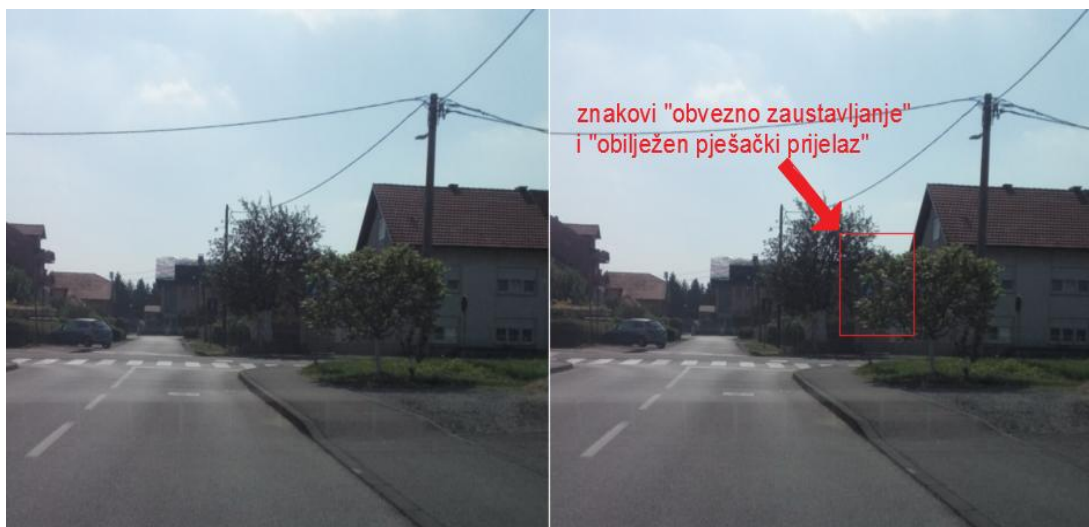
Slika 44. Primjer prometnih znakova zaklonjenih zelenilom i teško vidljivih vozačima
