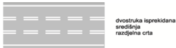
Slika 20. Dvostruka isprekidana razdjelna crta
