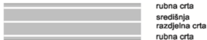
Slika 14. Puna uzdužna crta (razdjelna i rubna)
