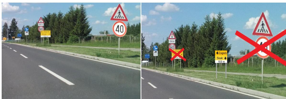
Slika 88. Uklanjanje nepotrebno postavljenih prometnih znakova
