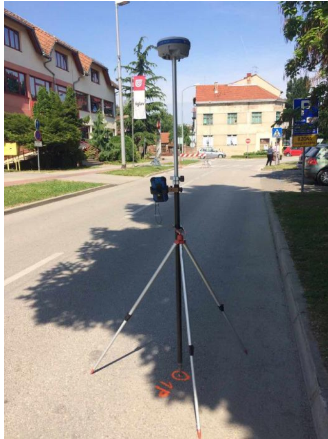
Slika 5.2. Stonex S9IIIN Plus GNSS
