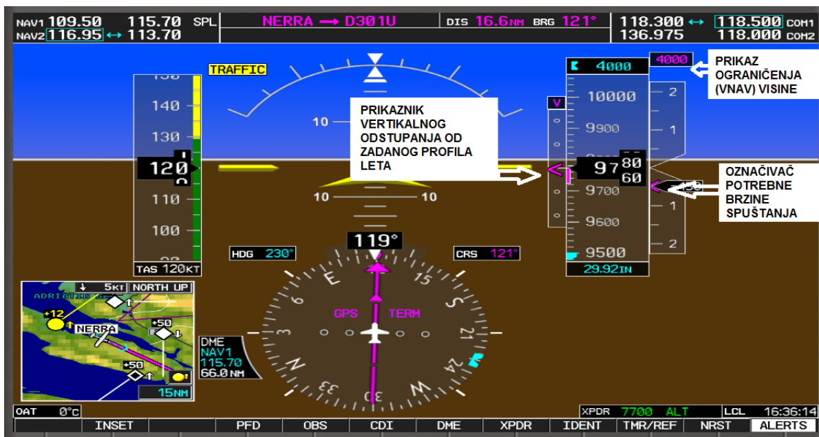
Slika 25. Prikaz VNAV vođenja zrakoplova na primarnom letnom prikazniku
