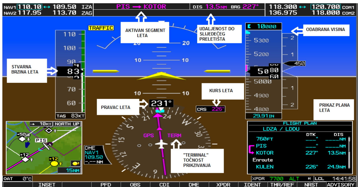
Slika 20. Primarni letni prikaznik za vrijeme penjanja prema preletištu KOTOR
