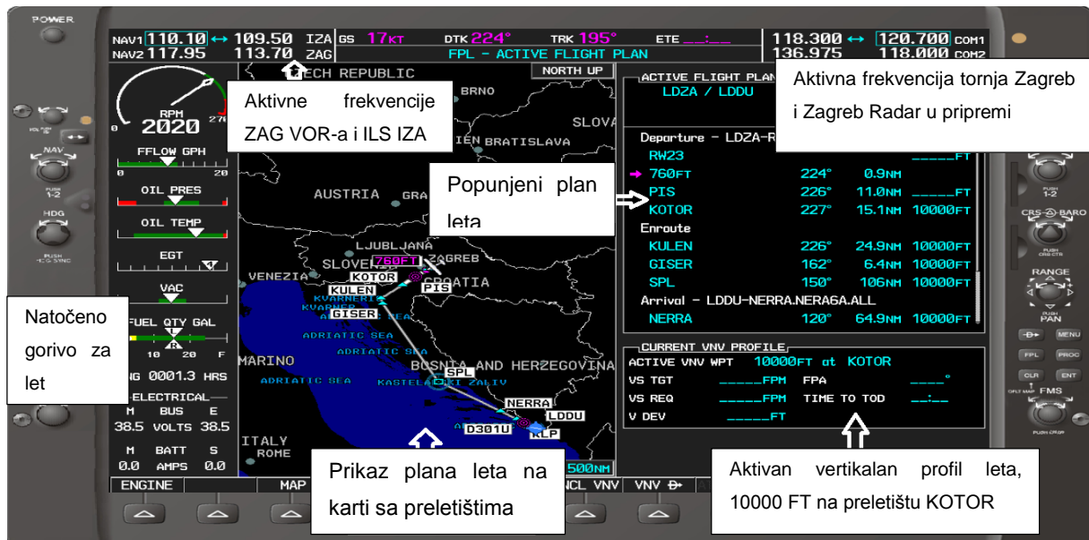
Slika 17. Višenamjenski prikaznik s ispunjenim planom leta
