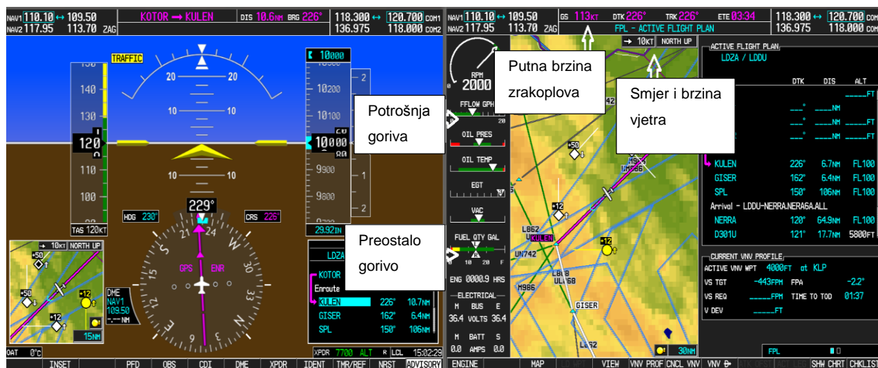
Slika 21. Primarni i višenamjenski letni prikaznik na segmentu rute KOTOR-KULEN
