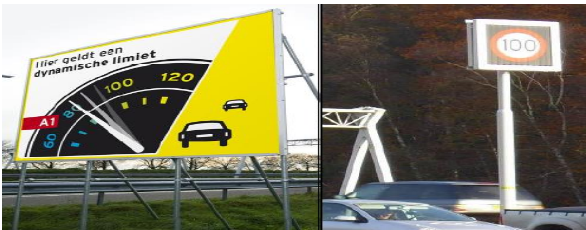
Slika 16. Table sa znakovima za početak dionice (lijevo), elektronički rotirajući znakovi (desno) [Izvor: Stoelhorst, H., Schreuder, M., Polderdijk, S. Summary results of Dutch field trials with dynamic speed limits (Dynamax), Rijkswaterstaat Centre for Transport and Navigation Delft, The Netherlands (2010.)]
