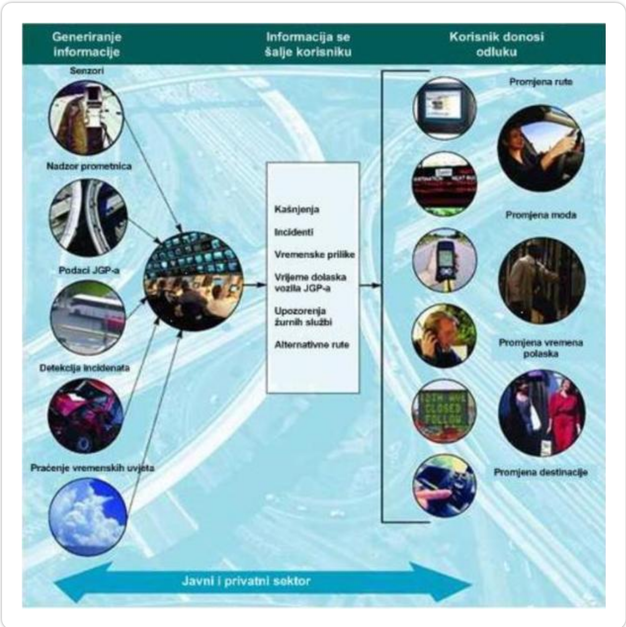
Slika 1. Sastavni dijelovi sustava predputnog informiranja [24]
