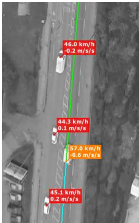
Slika 21. Prikaz praćenja i mjerenja brzine i akceleracije vozila, [12]
