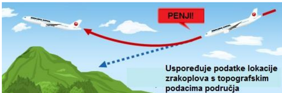
Slika 15. Načelo rada GPWS sustava [33]
