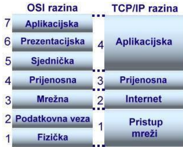
Slika 18. Usporedba slojeva modela OSI i TCP/IP
