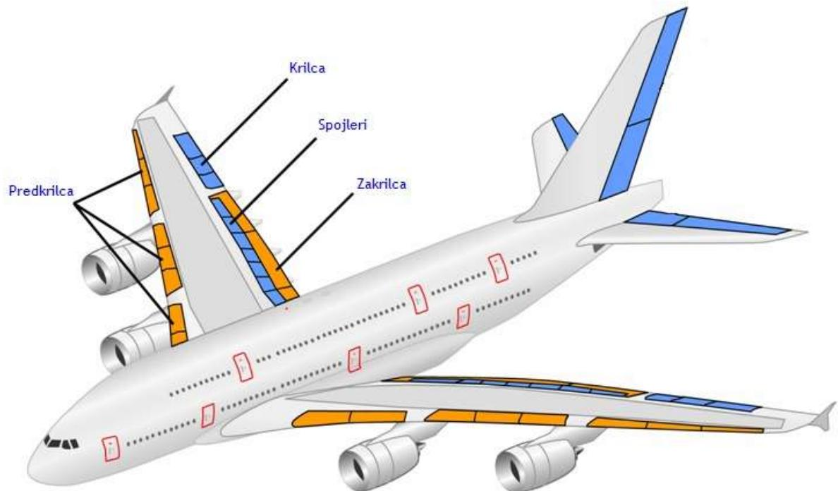
Slika 17. Uređaji za povećanje uzgona
