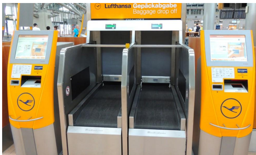
Slika 4.12. Lufthansin sustav registracije putnika putem samouslužnih kioska u međunarodnoj zračnoj luci Frankfurt, [10]
