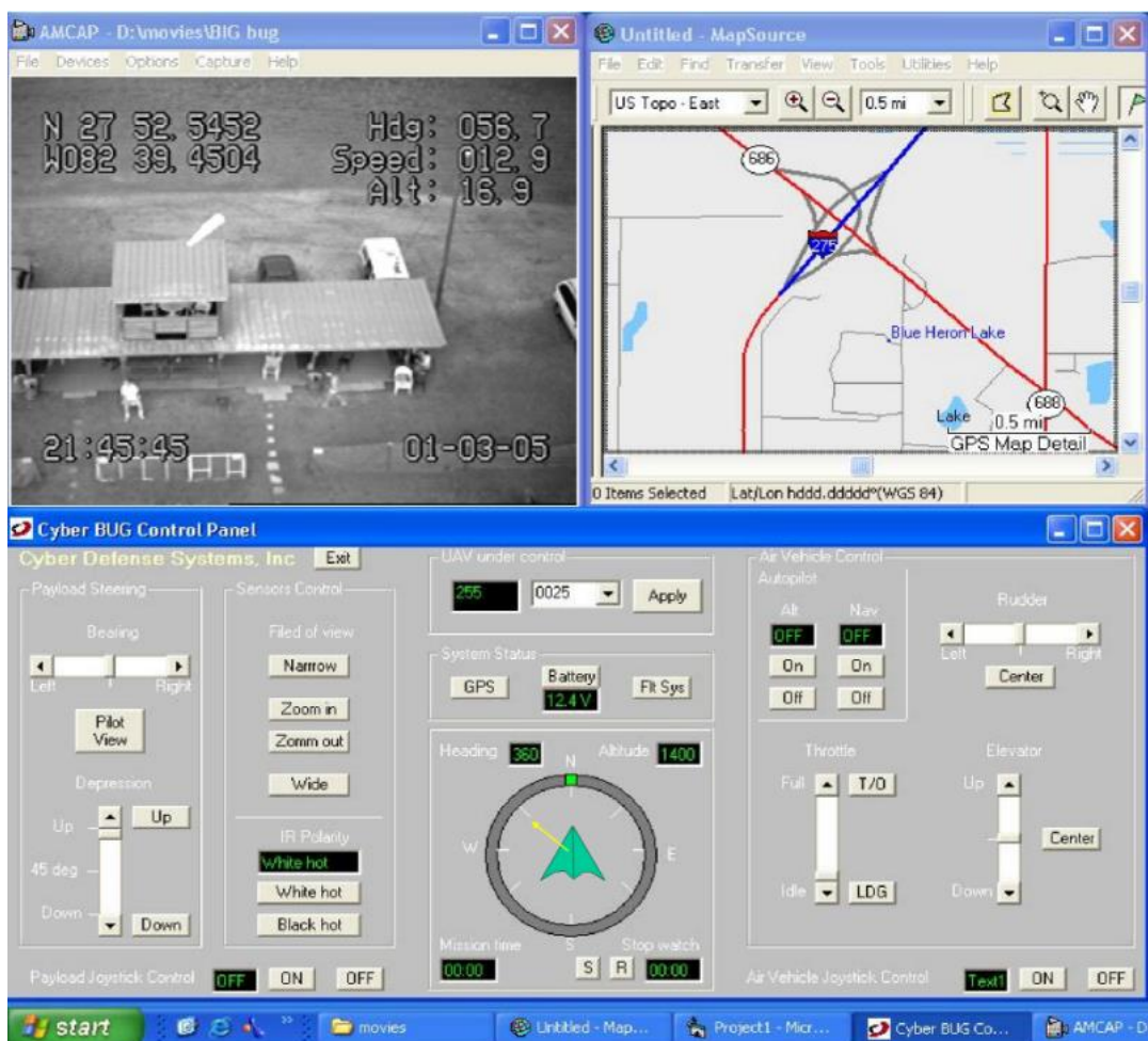
Slika 8. Video i upravljačko sučelje bespilotne letjelice, [11]
