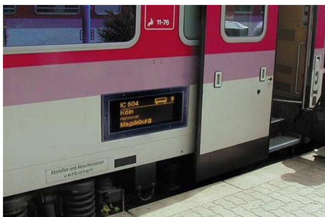
Slika 16-Uređaj za informiranje putnika na vagonu
