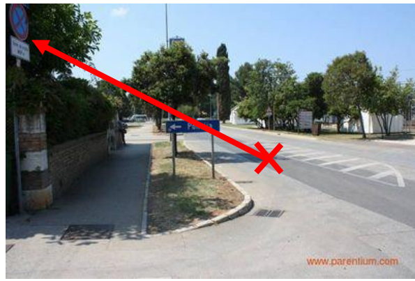
Slika 36. Loša vidljivost prometnih znakova [17] Slika 37. Prometni znak na nepropisnoj visini [18]
