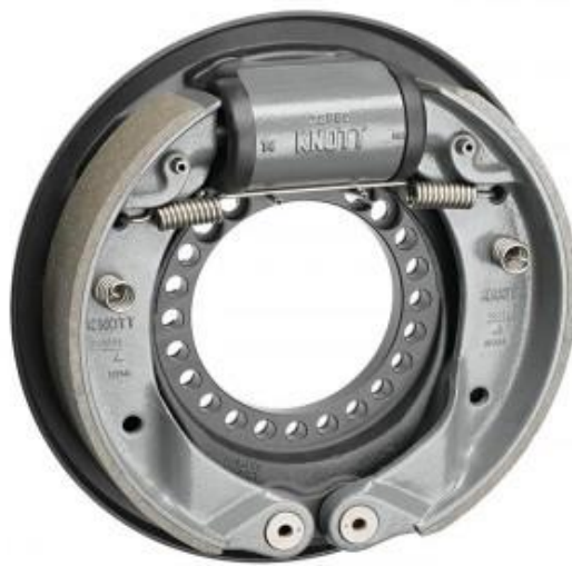
Slika 2. Simplex kočni sustav
