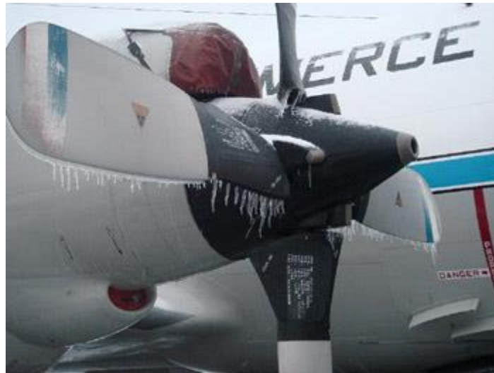
Slika 3. Zamrznuti propeler motora zrakoplova
