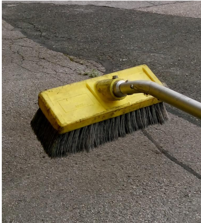
Slika 4. Metla za ručno čišćenje kontaminanta sa zrakoplova
