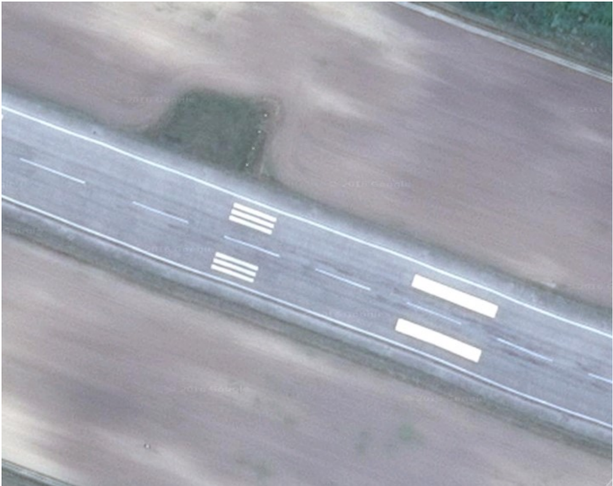
Slika 22. Oznaka ciljne točke zračne luke Osijek
