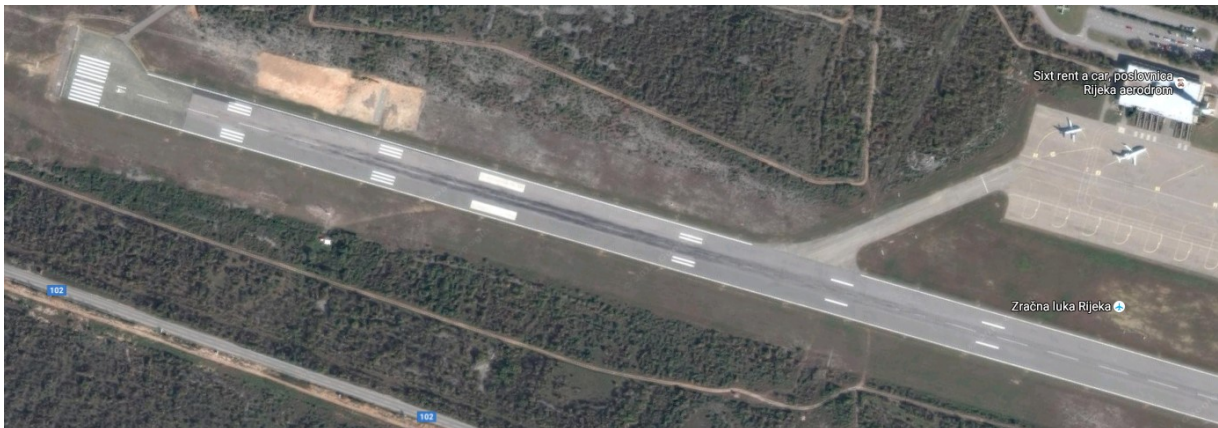
Slika 34. Oznake manevarske površine zračne luke Rijeka na strani praga 14
