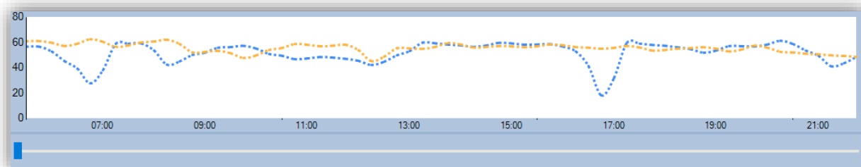
Slika 5. Grafikon dvosmjernih profila brzina sa jasno prikazanim vremenima zagušenja unutar aplikacije SegCalc
