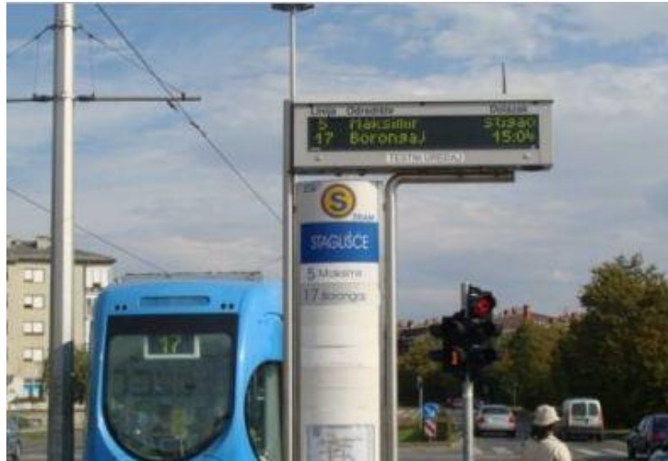
Slika 11. Promjenjivi svjetlosni znak
