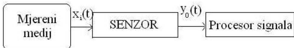
Slika 20. Input-output model senzora
