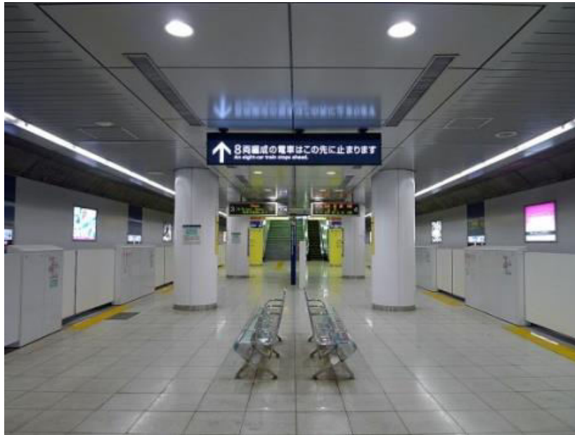
Slika 22. Stajalište sa automatiziranim vratima za izmjenu putnika u vozilima
