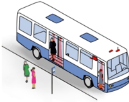
Slika 2. Skener koji infracrvenim zrakama skenira ulazak/izlazak putnika
