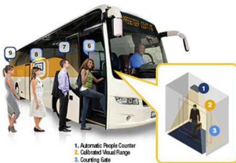
Slika 1. Automatski brojač putnika koji očitava polje preglednosti
