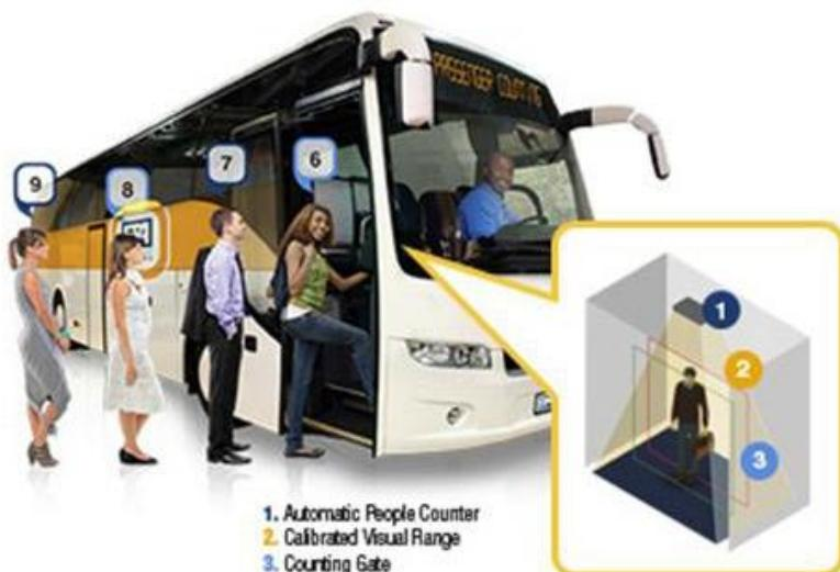
Slika 1. Automatski brojač putnika koji očitava polje preglednosti
