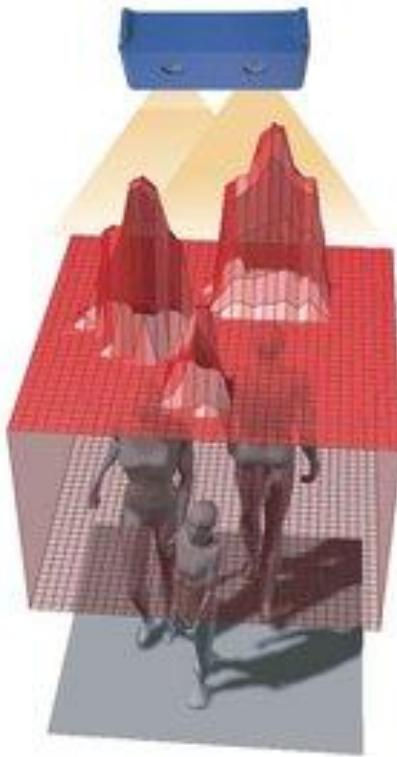
Slika 13. Infracevne zrake skenera koje služe za 3D skeniranja putnika
