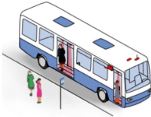
Slika 2. Skener koji infracrvenim zrakama skenira ulazak/izlazak putnika
