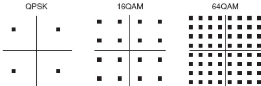
Slika 7. QPSK, 16 QAM i 64 QAM dijagrami stanja, [5]
