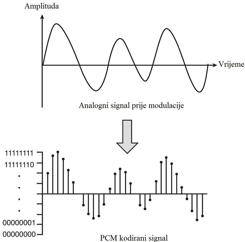
Slika 1. Usporedba analognog i PCM kodiranog signala, [4]
