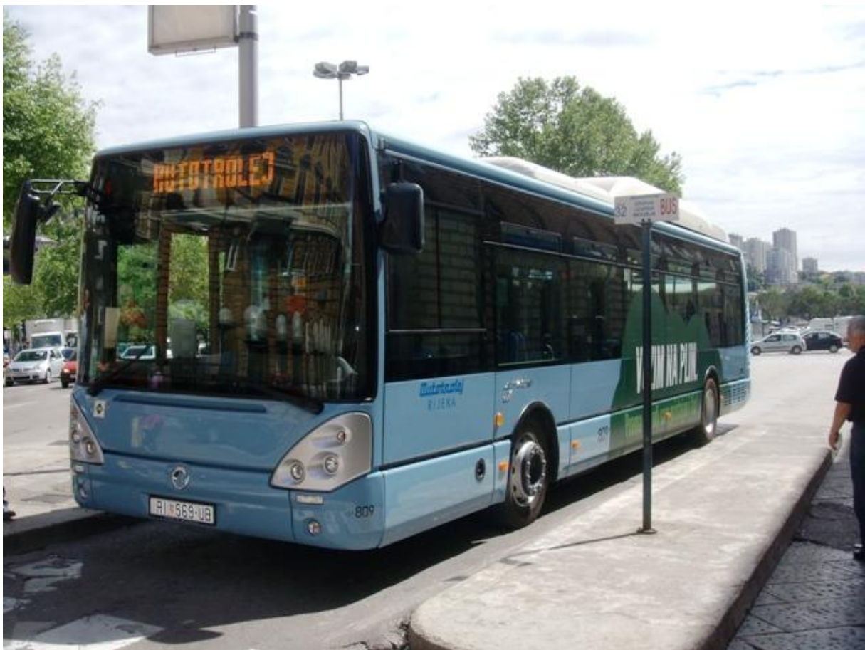
Slika 11. Autobus pogonjen stlačenim prirodnim plinom, [12]
