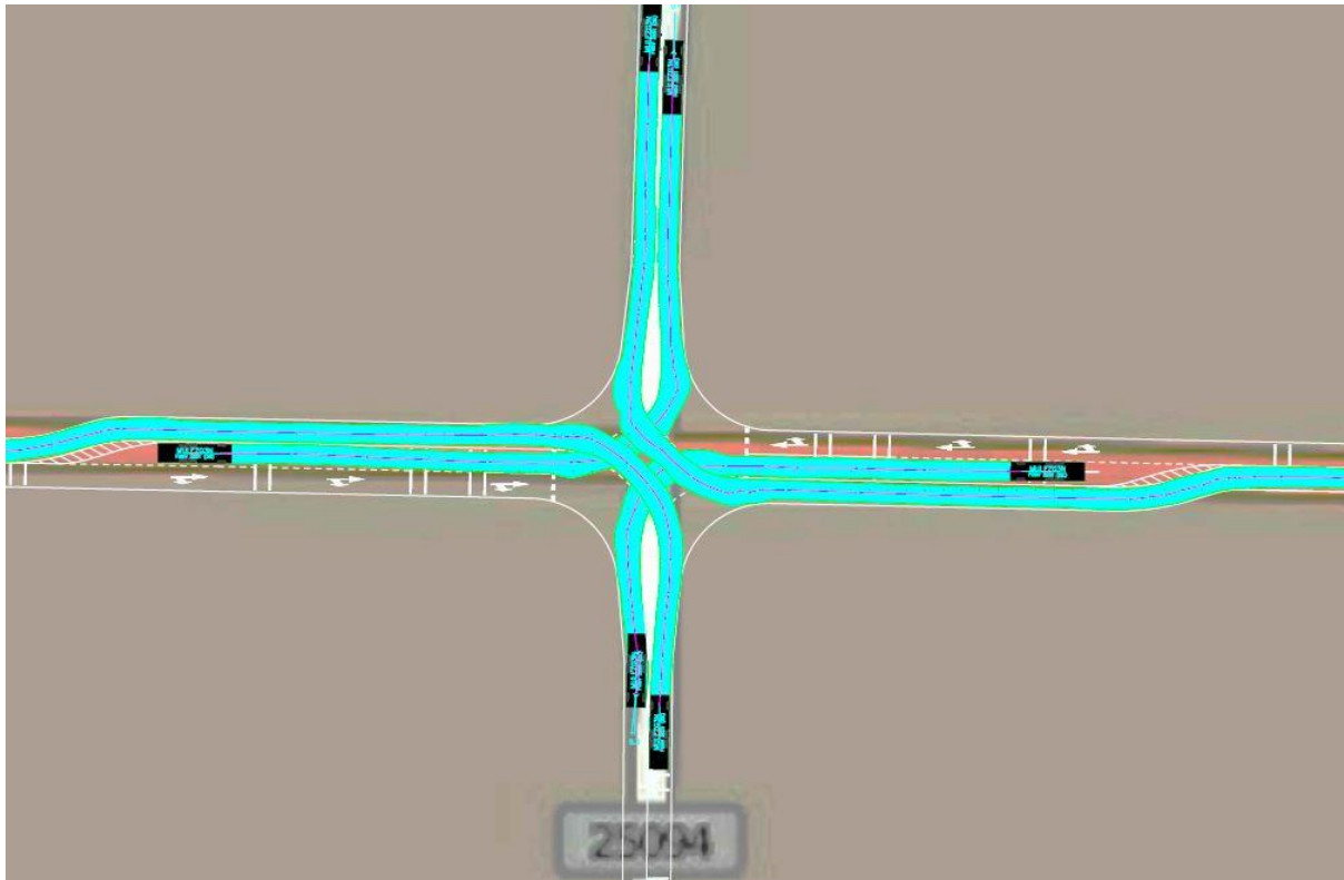
Slika 38. Četverokrako raskrižju u programskom alatu AutoTURN
