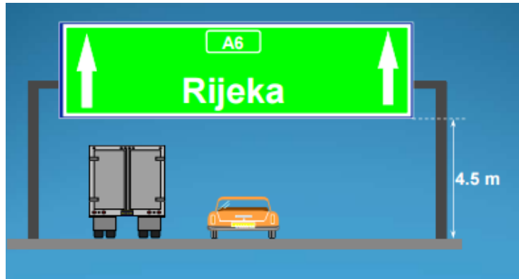
Slika 11. Postavljanje prometnih znakova iznad kolnika
