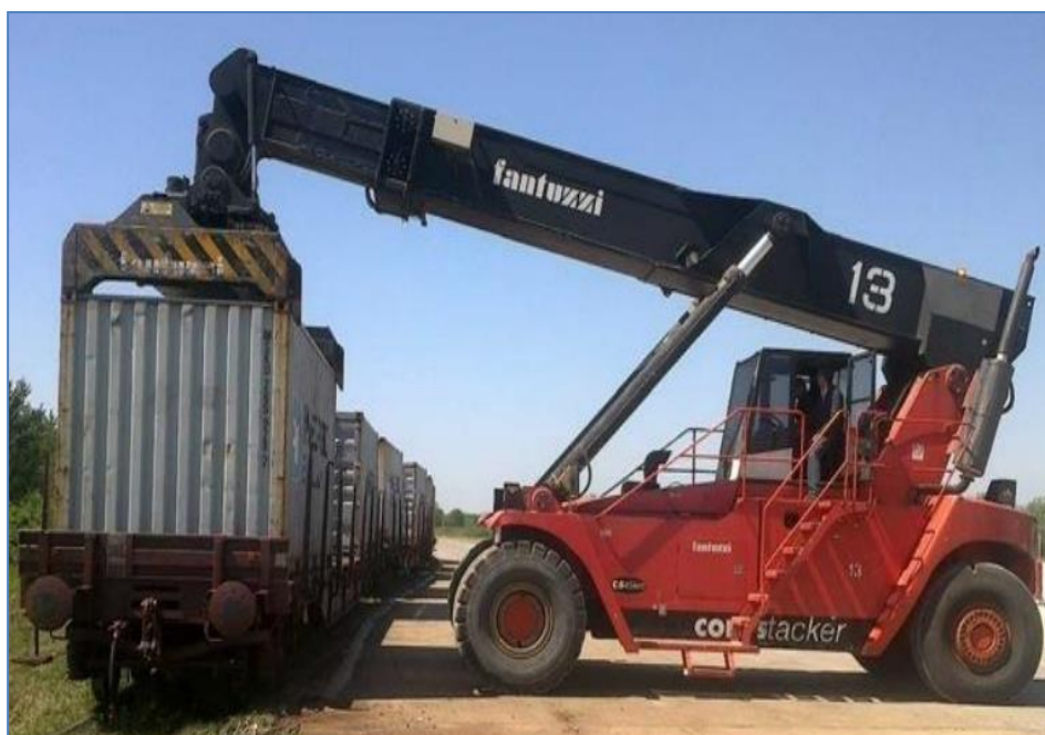
Slika 16. Prikaz ukrcanja kontejnera na vagon
