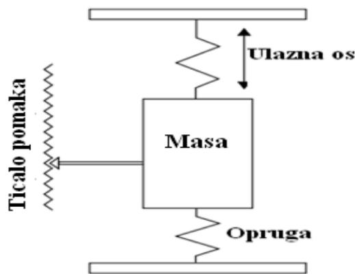
Slika 15. Princip akcelerometra [15]
