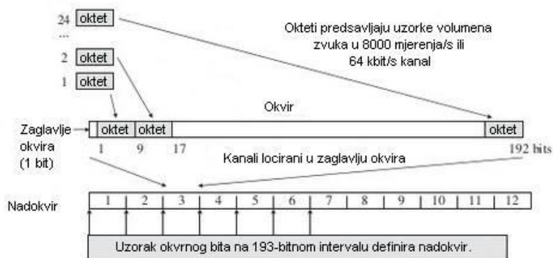
Slika 1. Formiranje TDM okvira. Preuzeto od [1].
