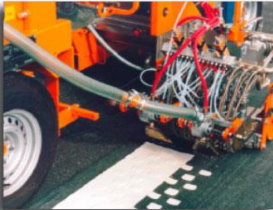
Slika 17. Prikaz stroja za nanošenje termoplastike-Extruder
