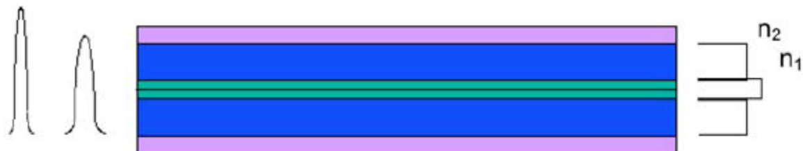
Slika 20. Jednomodni svjetlovod sa stepeničastim indeksom loma [9]
