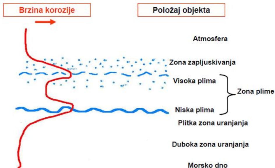
Slika 1. Brzina korozije u morskoj vodi u odnosu na položaj objekta
