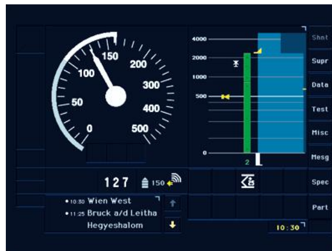
Slika 6. Prikaz kabinskog dijela ERTMS-a Izvor: http://www.humanefficiency.nl/ , (pristupljeno: lipanj 2016.)
