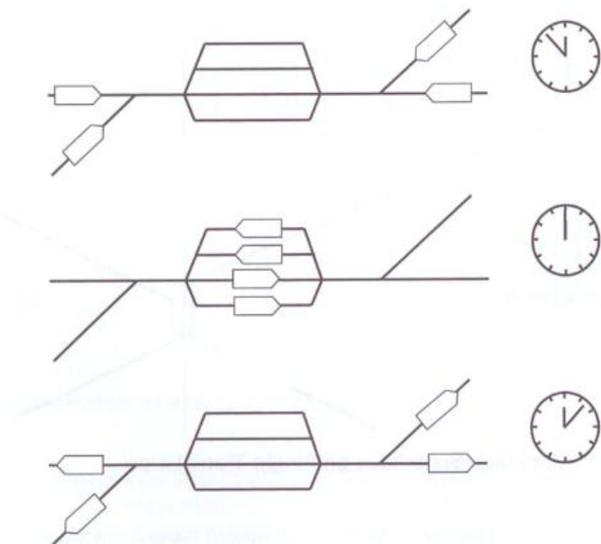
Slika 4.2. Princip rada integriranog taktnog voznog reda
