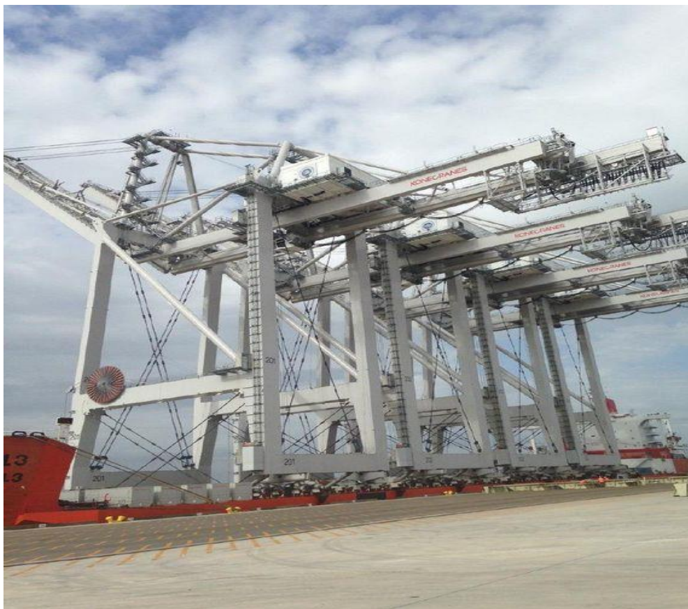
Slika 14. Super Post-Panamax Wharf dizalica Izvor: http://www.yourhoustonnews.com/ (kolovoz, 2015.)
