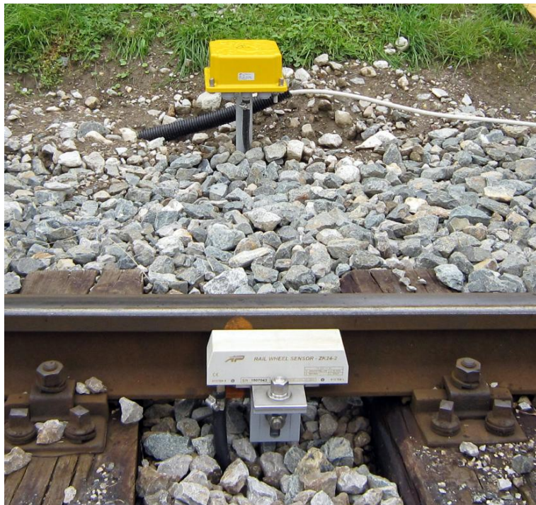
Slika 18. Senzor željezničkog kotača ZK24-2 (Altpro) [2].
