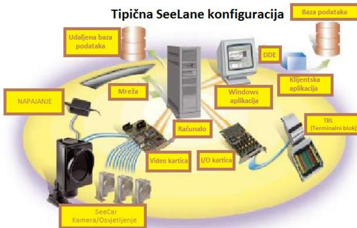
Slika 14. Tipična konfiguracija ALPR sustava [10]
