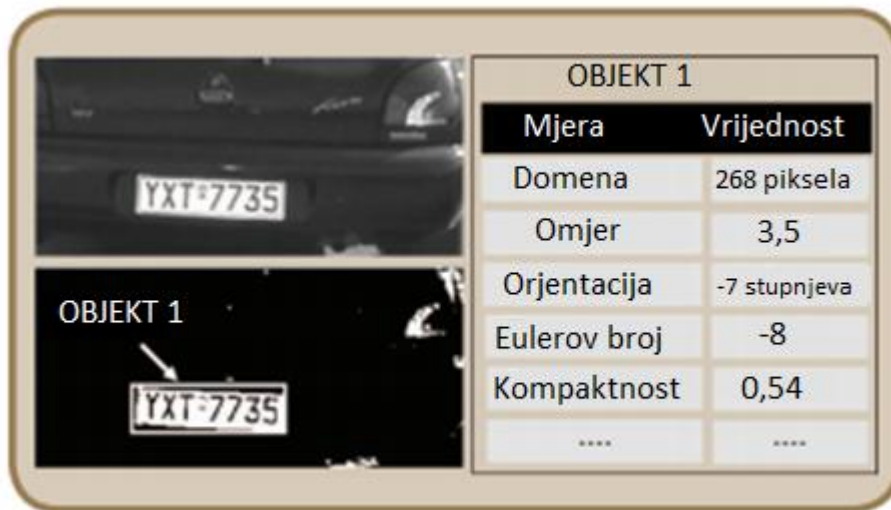
Slika 8. Oblik analize u binarnom objektu[13]
