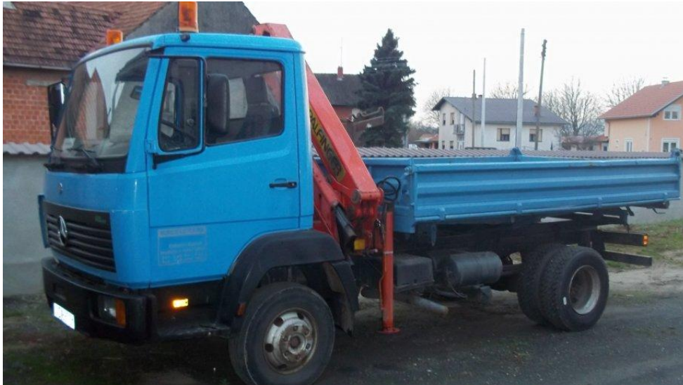
Slika 14 Vozilo sa hidrauličnom dizalicom
