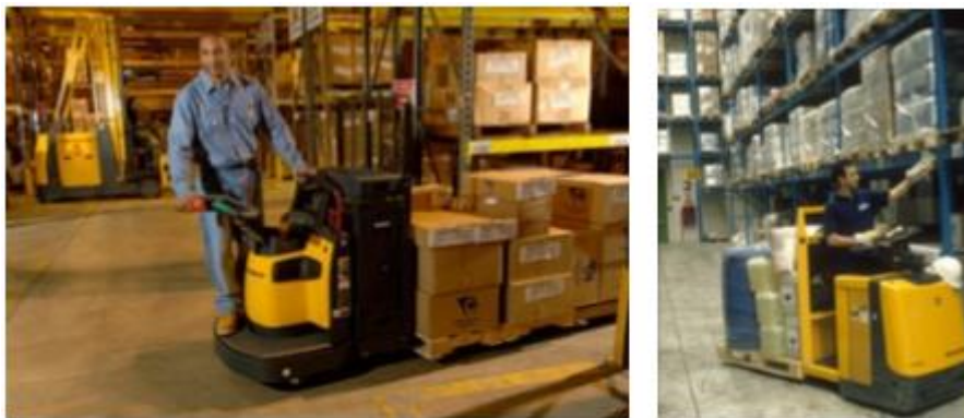
Slika 9: Prikaz viljuškara za horizontalan transport (paletna kolica; viljuškar komisionara za horizontalni transport)
