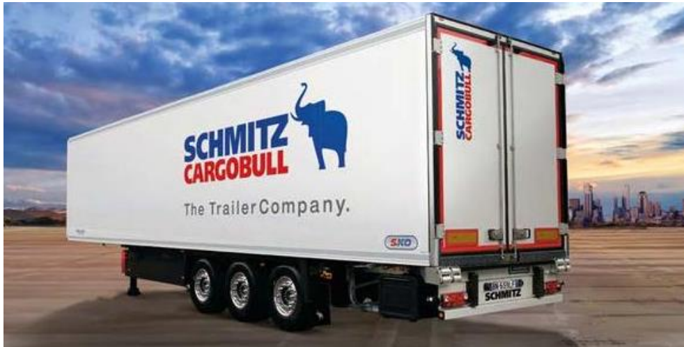
Slika 5. Poluprikolica s toplinski izoliranom nadogradnjom i uređajem za hlađenje
