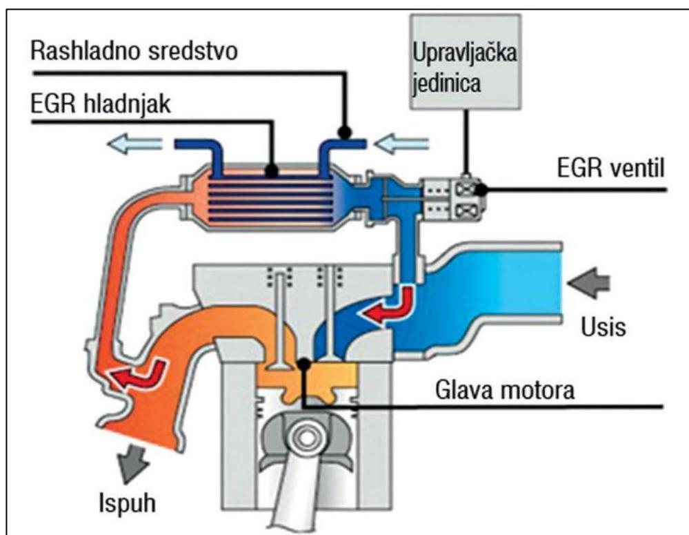
**Slika 10.** Prikaz sustava za povrat ispušnih plinova (EGR)
