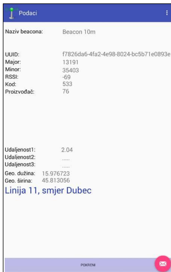
Slika 6.8. Sučelje aplikativnog rješenja predloženog sustava za informiranje – očitavanje dolaska vozila
