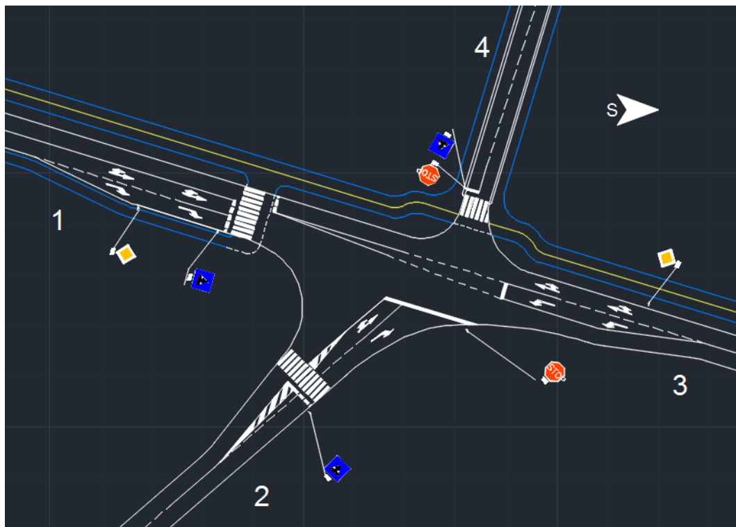
Slika 23. Prikaz konstrukcije raskrižja primjenom njemačkih smjernica
