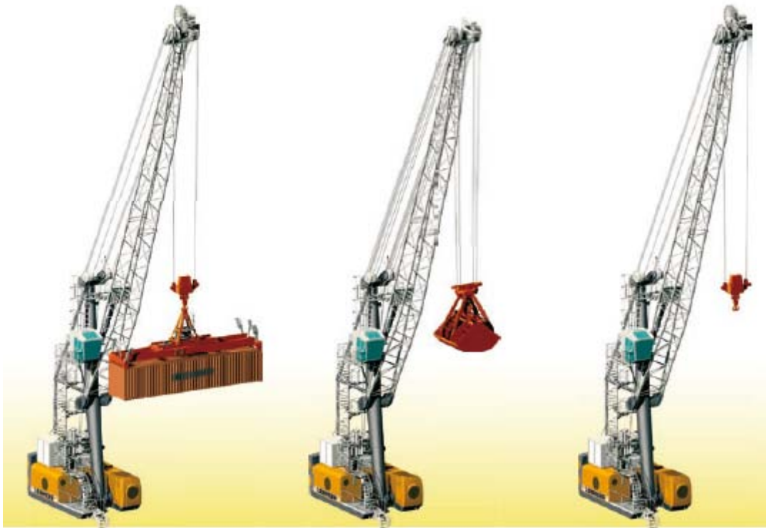
Slika 17. Planirana lučka dizalica za prekrcaj generalnog i rasutog tereta
