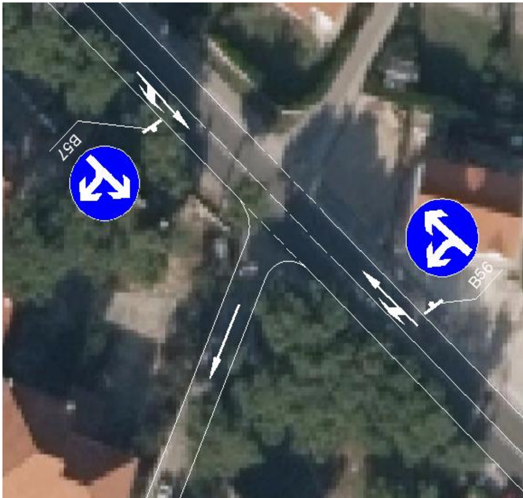
Slika 23. Prijedlog idejnog rješenja nove regulacije i organizacije prometnih tokova na križanju Jadranske ceste i ulice Obala Gaj
