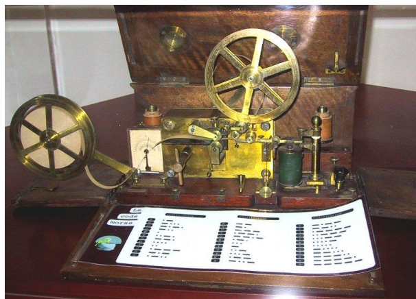
Slika 1. Prvi Morseov telegraf, [3]
