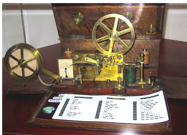
Slika 1. Prvi Morseov telegraf, [3]
