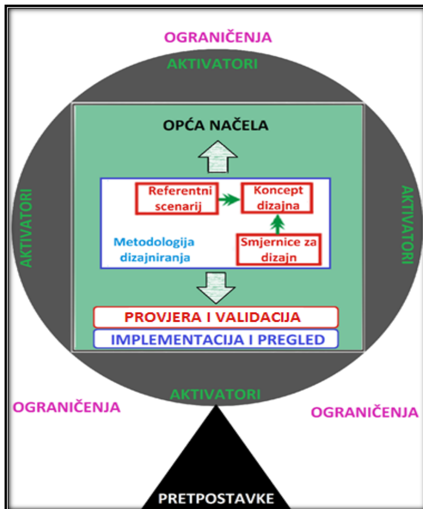
Slika 3: Shematski prikaz dizajniranja rutnog zračnog prostora [2] (prilagodio autor).
