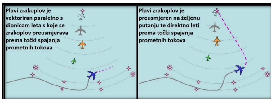
Slika 37: Shematski prikaz vektoriranja zrakoplova nakon preuranjenog izlaska iz putanje [28] (prilagodio autor).
